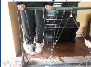
Se perforaron las patelas en el fragmento superior, por donde se atravesó un gancho en el cual se ancló la estructura al sistema de poleas. La porción inferior (tibia) se dejó anclada a un soporte de la máquina mecánica, donde topa con un fémur fijo, el cual entrega los 45° propuestos previamente, siendo el eje donde se provocará la mayor fuerza.
