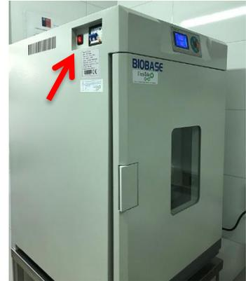
**Nota:** Si suena la alarma por sobrecalentamiento (sobrecarga de material), se debe abrir la puerta para ventilar y se debe sacar el material sobrecargado. Luego, se podrá cerrar la puerta sin que el equipo vuelva a alarmarse.
